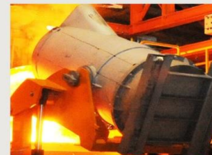
FÜLLUNG DER SANDFORM DER FLÜSSIGEM EISEN BEI 1500°
